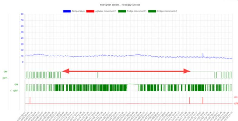
La surveillance assidue de l'activité du compresseur a permis la détection d'un gaspillage d'énergie: Le compresseur était en marche pour une longue période alors qu'il est censé être en repos.
